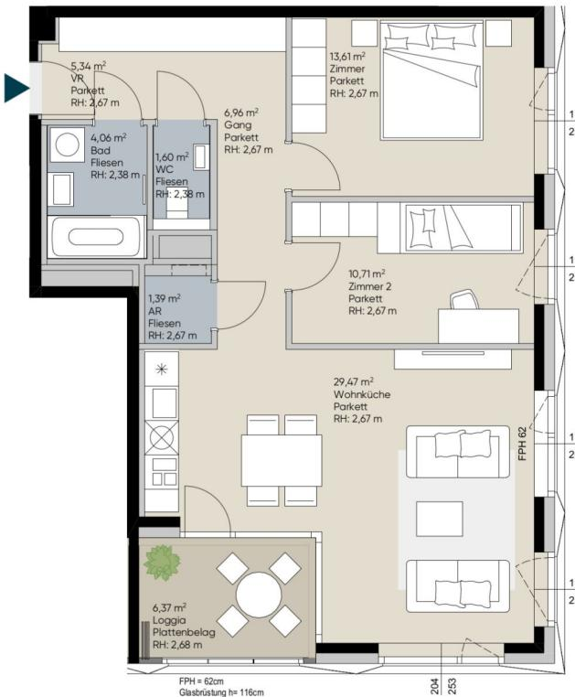
FPH = Fertigparapethöhe      Glasbrüstung h = Glasbrüstungshöhe      RH = Raumhöhe      Fenstergröße Breite | Höhe
