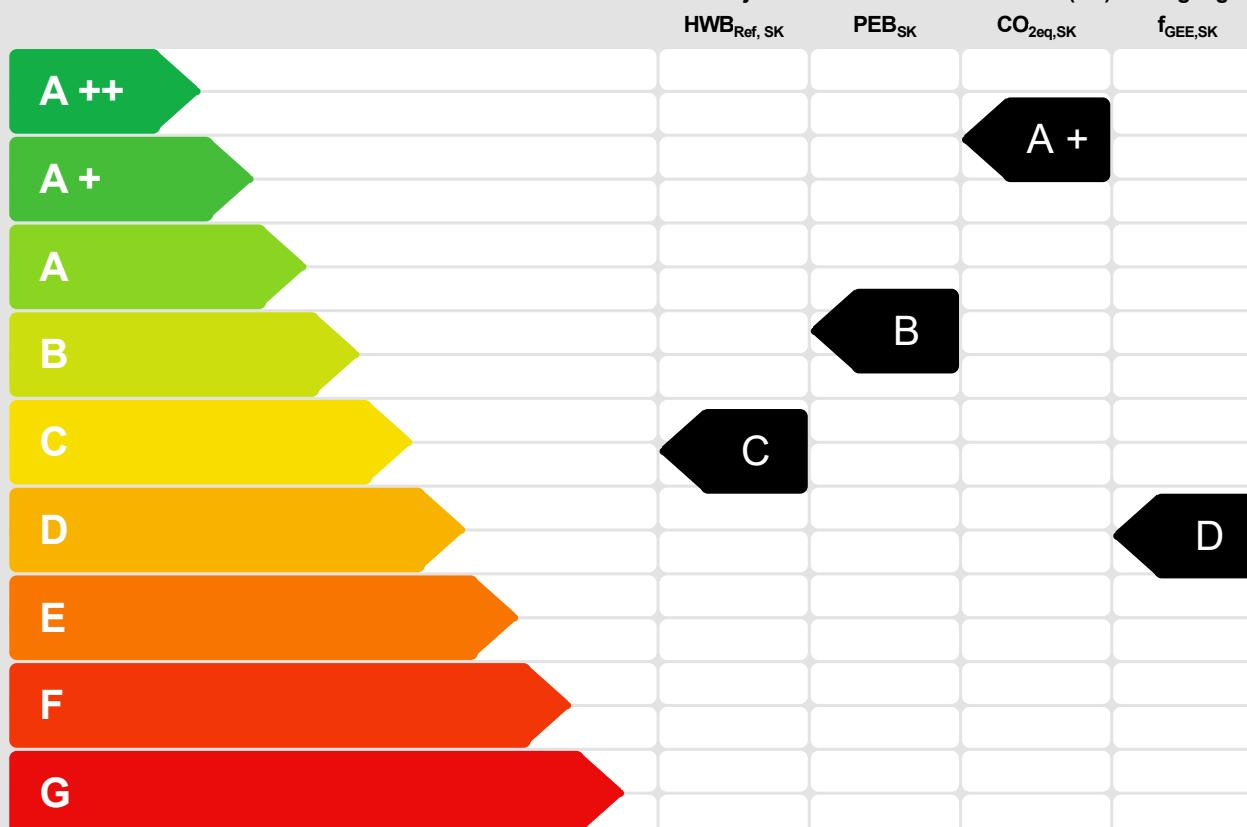
**HWB<sub>Ref</sub>:** Der Referenz-Heizwärmebedarf ist jene Wärmemenge, die in den Räumen bereitgestellt werden muss, um diese auf einer normativ geforderten Raumtemperatur, ohne Berücksichtigung allfälliger Erträge aus Wärmerückgewinnung, zu halten.
