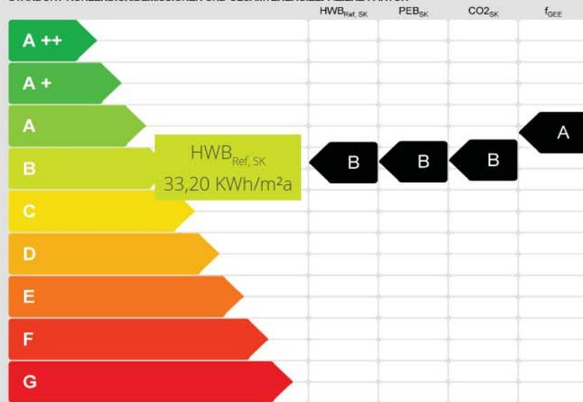
**HWB<sub>Ref, SK</sub>:** Der Referenz-Heizwärmebedarf ist jene Wärmemenge, die in den Räumen bereitgestellt werden muss, um diese auf einer normativ geforderten Raumtemperatur ohne Berücksichtigung allfälliger Erträge aus Wärmerückgewinnung, zu halten.
