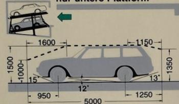
Einzelheiten zu Bauart, zulässiger Stellplatzbelastung und max. PKW-Abmessungen entnehmen Sie der Bedienungsanleitung.
